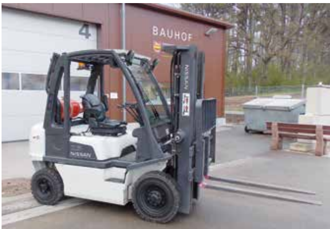
Stapler, Nissan 2,5t , Baujahr 2011, 53 PS, Verladen von verschiedensten Materialien, Befördern von Paletten, Kisten usw.
