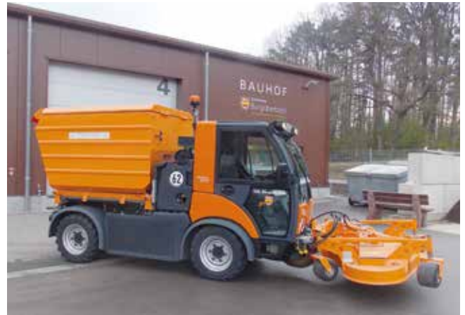
Multicar Geräteträger, HAKO M 29 C , Baujahr 2019, 80 KW, Zugfahrzeug, Transportfahrzeug, Fahrzeug im Winterdienst, Anbau von verschiedensten Geräten im Front- und Heckbereich
