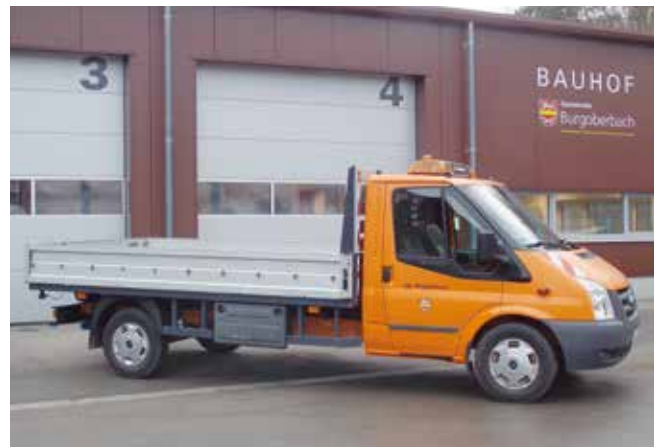
Pritschenwagen, Ford Transit , Baujahr 2010, 85 KW, Zugfahrzeug, Transport- und Einsatzfahrzeug
