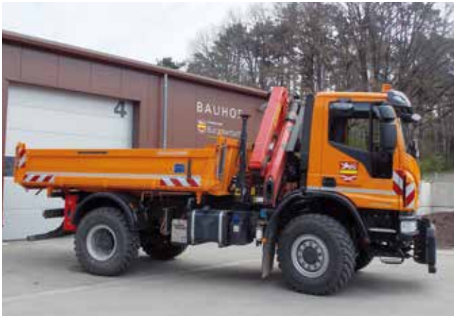
LKW Kipper mit Kran, IVECO Eurocargo 150–260 , Baujahr 2020, 207 KW, Zugfahrzeug, Transportfahrzeug, Fahrzeug im Winterdienst
