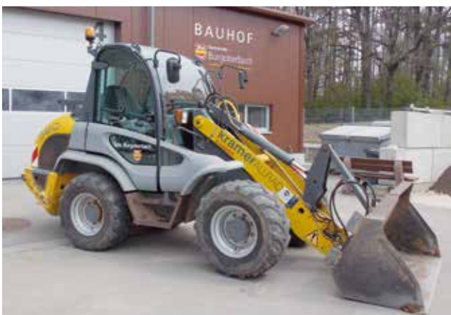
Radlader, Kramer Typ 380 , Baujahr 2004, 44 KW, Zugfahrzeug, Verladen von verschiedensten Materialien, Fahrzeug im Winterdienst
